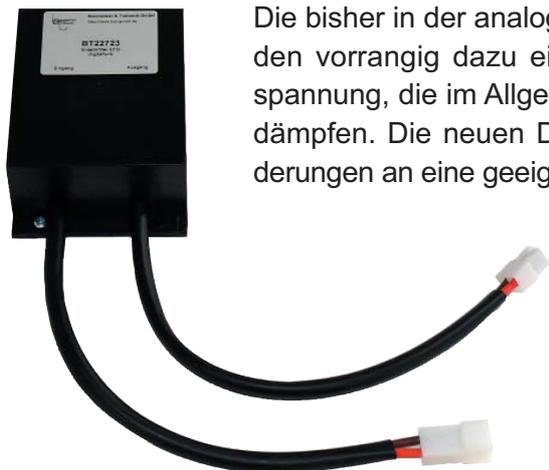
Die bisher in der analogen Funktechnik eingesetzten Entstörfilter EF3 und EF5 wurden vorrangig dazu eingesetzt, um Wechselspannungsanteile der Versorgungsspannung, die im Allgemeinen von der Lichtmaschine des Fahrzeugs ausgehen, zu dämpfen. Die neuen Digital-Funkgeräte unterscheiden sich deutlich in den Anforderungen an eine geeignete Stromversorgung gegenüber den analogen Funkgeräten.
