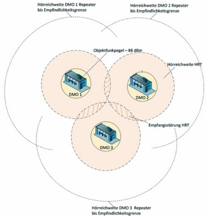
Überlappende Hörreichweiten von DMO-Objektfunkanlagen führen zur Deaktivierung von DMO-Repeatern. Im dargestellten Beispiel ist immer nur eine Objektfunkanlage von dreien aktiv (Voraussetzung: kein Standby-Betrieb, gleicher DMO-Kanal).
