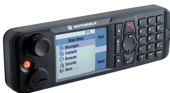
ETHERNET-REMOTE-BEDIENTEIL (RECH) UNTERSTÜTZT EXTERNE LAUTSPRECHER UND SPRECHTASTE
