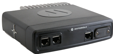
ETHERNET-ERWEITERUNGSKOPF 2X ETHERNET-STD, ETHERNET-SIM-LESEGERÄT UND RS232
